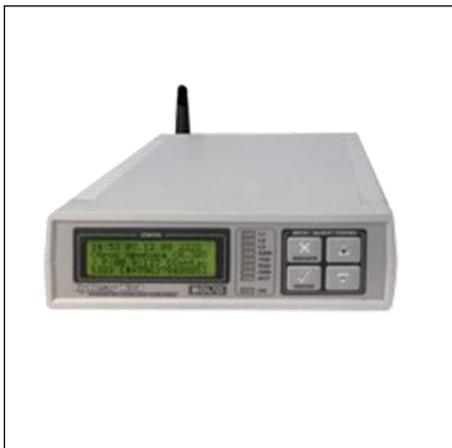
Устройство оконечное пультовое предназначено для работы в комплексах охранно-пожарной сигнализации, обеспечивает одновременный независимый прием, декодирование и трансляцию извещений, поступающих по двум коммутируемым линиям проводной телефонной сети и по сети GSM, отображение событий на дисплее в текстовом виде.
