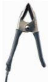
Зонд-зажим (т/п типа К) для измерения температуры на трубах Ø 15-25 мм – Диапазон измерений -50 ... +100°C, краткосрочно до +130°C
