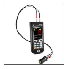
Ультразвуковой толщиномер «А1209» предназначен для измерения толщины изделий из металла, пластика, стенок труб, а так же изделий с высоким затуханием ультразвука.
