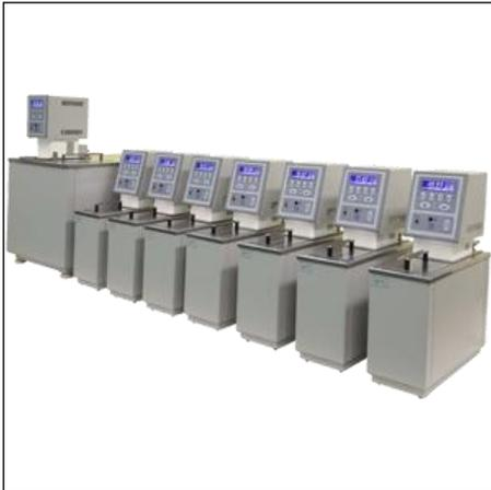
Установка для кондиционирования проб жира. Предназначена для одновременной подготовки образцов при температурах 0, +5, +10, +20, +30, +40 и +50 С° для последующего анализа.
