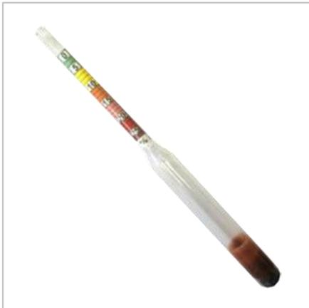
Ареометры для соли АСО-1, АСО-2 используется для измерения содержания соли в жидкостях.
