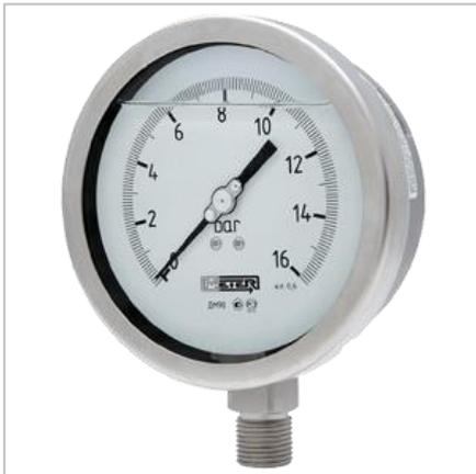
Манометры общетехнические ДМ93 предназначены для измерений давления газообразных и жидких, не сильно вязких и не кристаллизующихся сред, не агрессивных по отношению к нержавеющей стали. В виброустойчивом исполнении для мест с повышенной вибрацией и пульсацией.
