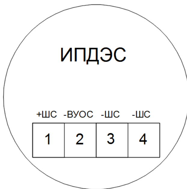
Рис. 8.1. Схема разметки места установки извещателя.
