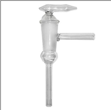
Вакуумные краны применяют в различных вакуумных установках, приборах, аппаратах для соединения или разобщения отдельных частей вакуумной системы.
