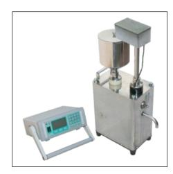
Влагомер предназначен для измерения объемного влагосодержания в пробах нефти в процентах в диапазоне от 0% до 100%.
