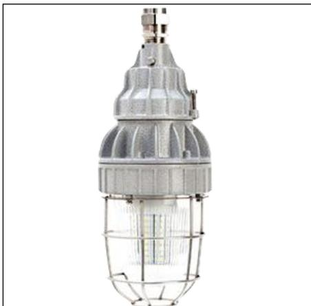
Взрывозащищенные светильники серии СГЖ01 для ламп с патроном E27 предназначены для освещения помещений промышленных предприятий, открытых промышленных площадок, и других мест, где возможно присутствие взрывоопасных сред. Взрывозащищенные светильники серии СГЖ01 состоят из алюминиевого корпуса со встроенным патроном и термостойкого ударопрочного боросиликатного колпака, крепящегося к корпусу с помощью резьбы.
