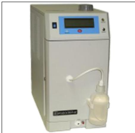
Прибор «ВОДОЛЕЙ-М» предназначен для получения в лабораторных условиях воды аналитической степени чистоты, используемой для ВЖХ, электрофореза, приготовления растворов, хроматографических проб, заправки электролизных генераторов водорода/кислорода и других целей.
