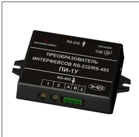
Преобразователь интерфейсов RS232-RS485 ПИ 1У предназначен для передачи информации между интерфейсами RS-232 и RS-485. Используется для объединения устройств в информационную сеть и для увеличения длины линии связи от персонального компьютера до устройства.
