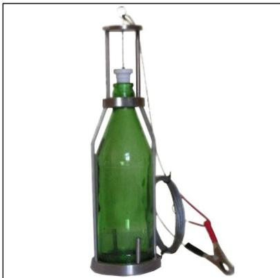
Пробоотборник **ППН-500К** представляет собой бутылку в каркасе, предназначенную для отбора проб легких нефтей, масел, светлых нефтепродуктов.
