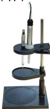
Современный бюджетный комплекс на базе анализатора «Экотест-ВА» в комплектации электрохимическим датчиком «ВДЭ» с вращающимся дисковым электродом предназначен для измерения тяжелых металлов в различных объектах анализа.
