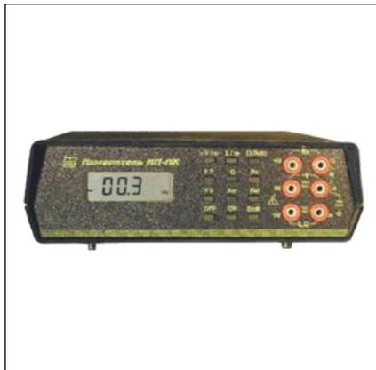
Измеритель параметров локомотивных катушек ИП-ЛК предназначен для контроля аппаратуры автоматической локомотивной сигнализации (АЛС) на локомотиве и в условиях железнодорожного депо.
