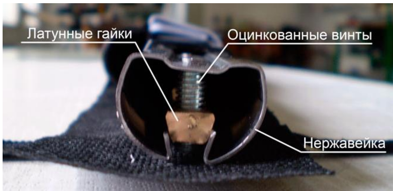
Соединение метроштока с Т-образным профилем
