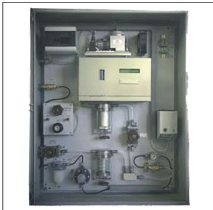
Газоаналитический комплекс СГК-17 предназначен для анализа сернистого ангидрида SO<sub>2</sub> в отходящих газах печей обжига концентратов, сжигания элементарной серы, в производстве серной кислоты. Применяется на предприятиях химической, нефтеперерабатывающей отрасли, в цветной металлургии.
