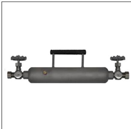
Бесшовный пробоотборник ПГО-400 предназначен для отбора проб сжиженных углеводородных газов. Пробоотборники применяются для отбора углеводородных газов, находящихся под избыточным давлением собственных паров из стационарных емкостей (цилиндрических, шаровых, железнодорожных цистерн, баллонов, а также из трубопроводов при перекачке газов путем продувки его сжиженным газом).
