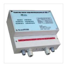
Адаптер связи взрывозащищенный ACB-1 предназначен для организации взрывобезопасного питания электронного корректора, установленного во взрывоопасной зоне, а также искрозащиты сигнальных цепей передачи информации при приеме и трансляции импульсного кода.
