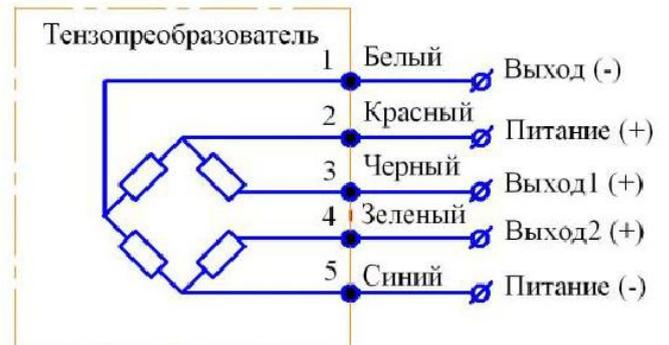
Электрическое соединение - гибкий провод сечением 0,09 мм<sup>2</sup> в тефлоновой изоляции.
