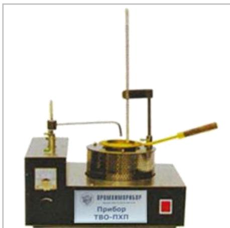
Прибор предназначен для определения температуры вспышки нефтепродуктов, нагреваемых с установленной скоростью в открытом тигле, в момент вспышки паров нефтепродуктов над его поверхностью от зажигательного устройства.
