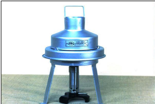
Предназначен для определения коксуемости масел, топлив и других нефтепродуктов по ГОСТ 19932 и ASTM D 189 путем их сжигания при определенных условиях и количественного определения углистого остатка – кокса.
