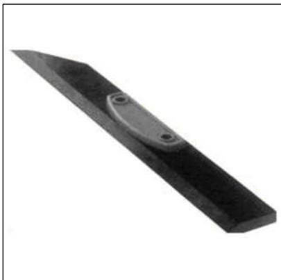
Поверочная лекальная линейка типа «ЛД» служит для проверки прямолинейности поверхностей по методу световой щели «на просвет» или с помощью щупов.
