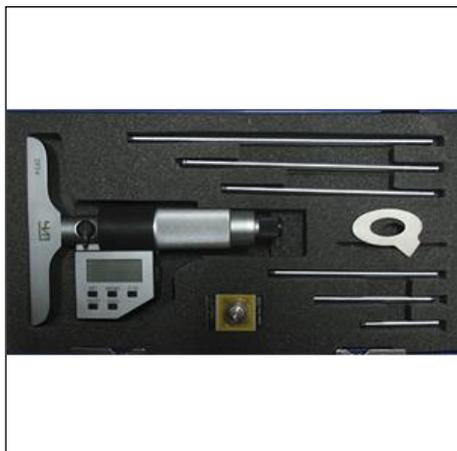
Глубиномер микрометрический ГМЦ предназначен для измерения глубины пазов, отверстий и высоты уступов.
