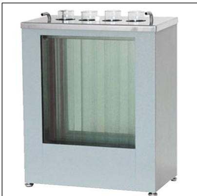
Испытательная ванна **LOIP LA-380** предназначена для определения плотности нефтепродуктов с помощью ареометров в температурном диапазоне от -40 °С до +50 °С по ГОСТ 3900-85 и ГОСТ Р 51069-97.
