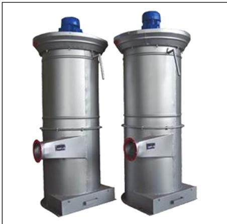
Пылеулавливающие агрегаты ЗИЛ-900, ЗИЛ-1600 используются на предприятиях, занимающихся обработкой металла, они идеально очищают воздух в помещениях от мелкой металлической пыли. Всасывают металлическую стружку непосредственно на металлорежущих и шлифовальных станках.
