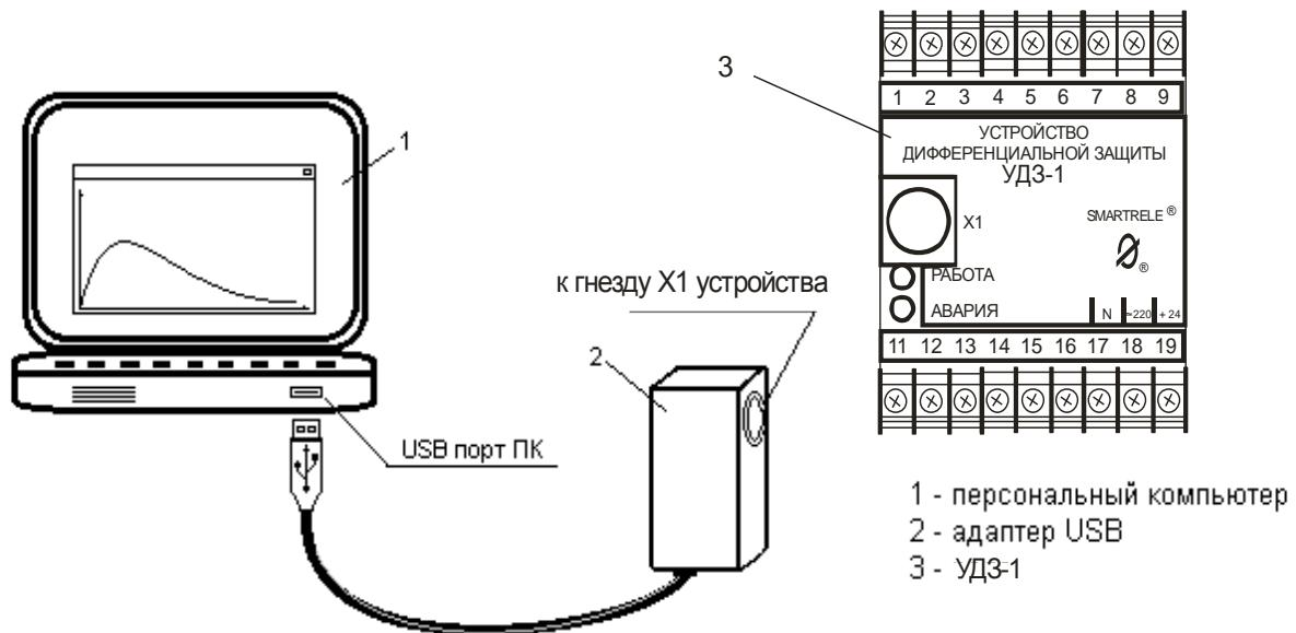
Рисунок 3 – подключение устройства к ПК с помощь адаптера USB
