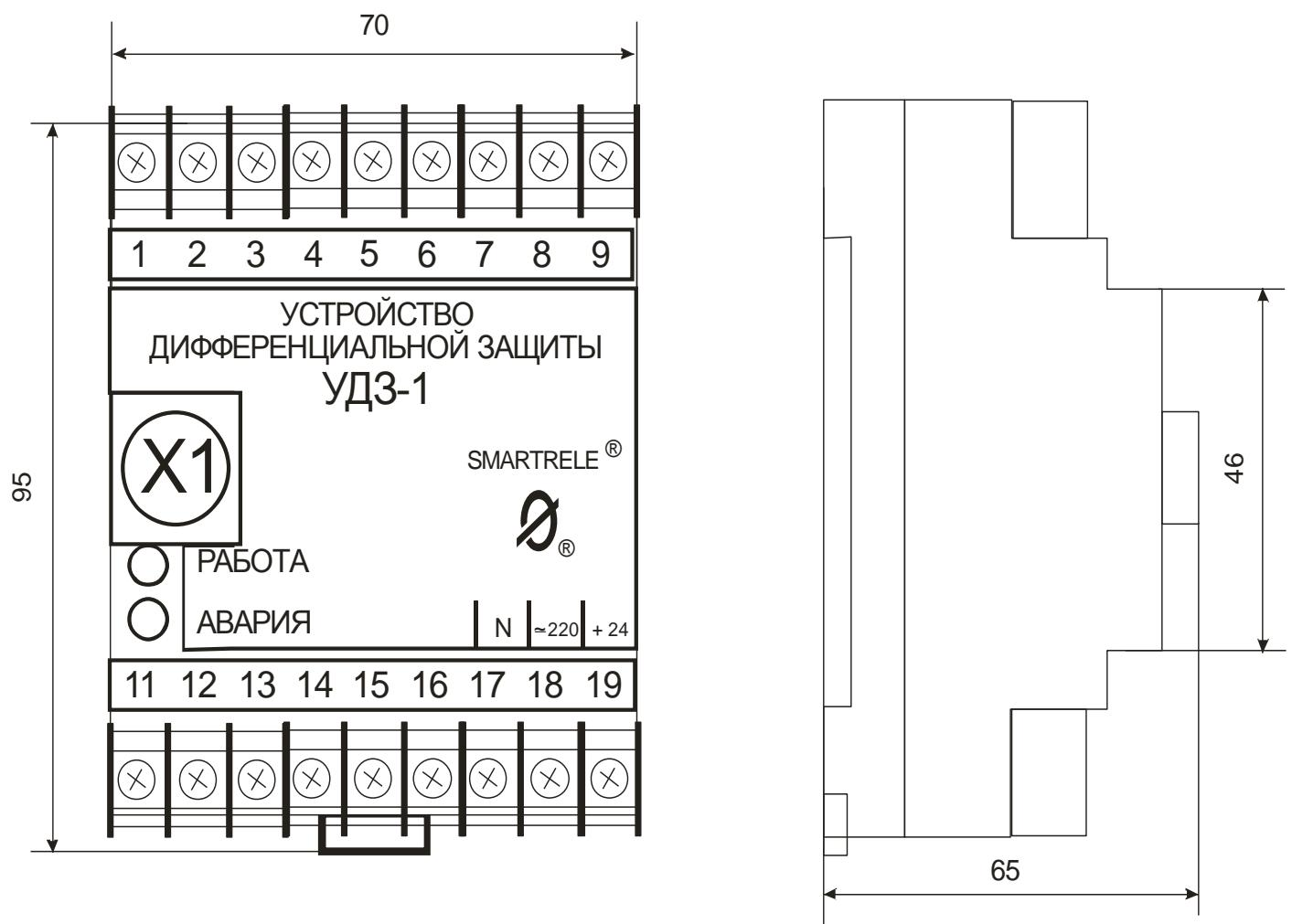
Рисунок 21 – внешний вид, габаритные размеры устройства
