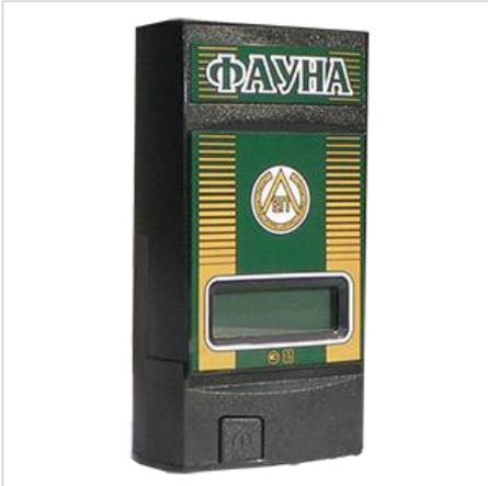
Влагомер щепы Фауна-ПЩ представляет собой микропроцессорный прибор, предназначенный для измерения влажности древесной щепы лиственных пород по ГОСТ 2695 (бук, ольха) при заготовке, сушке и хранении в производственных условиях лесопромышленных, деревообрабатывающих предприятий, мебельных комбинатов и строительстве, где необходим экспресс анализ влажности непосредственно на месте отбора проб.
