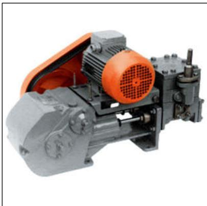
Поршневые электронасосные агрегаты типа «АН» предназначены для перекачки воды за исключением морской и питьевой, а также нейтральных жидкостей температурой от -15 до 80 °С (от 258К до 353К) и кинематической вязкостью от  $0,008 \times 10^{-4}$  до  $8 \times 10^{-4}$  м<sup>2</sup>/с. Агрегаты АН применяются в водоподготовке котельных агрегатов малой мощности и системах питания.
