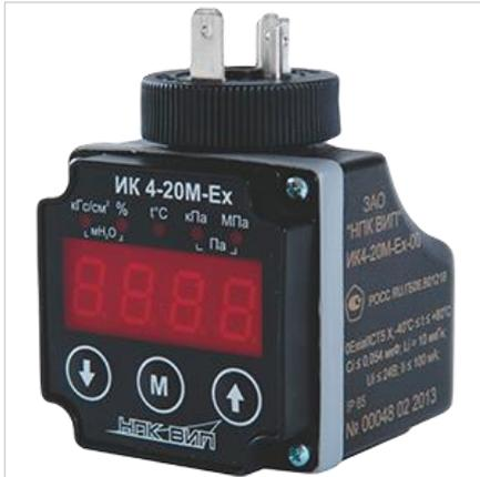
Индикатор-коммуникатор ИК-4-20М предназначен для индикации давления в установленных пользователем единицах измерения, настройки и управления датчиками давления СДВ с унифицированным токовым выходным сигналом 4-20 мА. ИК 4-20М может применяться для переключения диапазонов измерения многопредельных датчиков давления.
