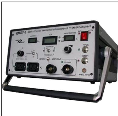
Дефектоскоп предназначен для намагничивания изделий или их участков в режимах импульсного, переменного, постоянного поля. Импульсное намагничивание производится пропусканием тока по участку объекта или кабелем, намотанным на изделие. Намагничивание постоянным и переменным полем производится катушками или электромагнитом. Для всех режимов предусмотрено размагничивание.
