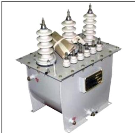
Трехфазные трансформаторы напряжения масляные типа НАМИ являются масштабными преобразователями и предназначены для выработки сигнала измерительной информации для электрических измерительных приборов, цепей защиты и сигнализации в сетях переменного тока с изолированной или с заземленной через дугогасящий реактор нейтралью частотой 50 Гц.
