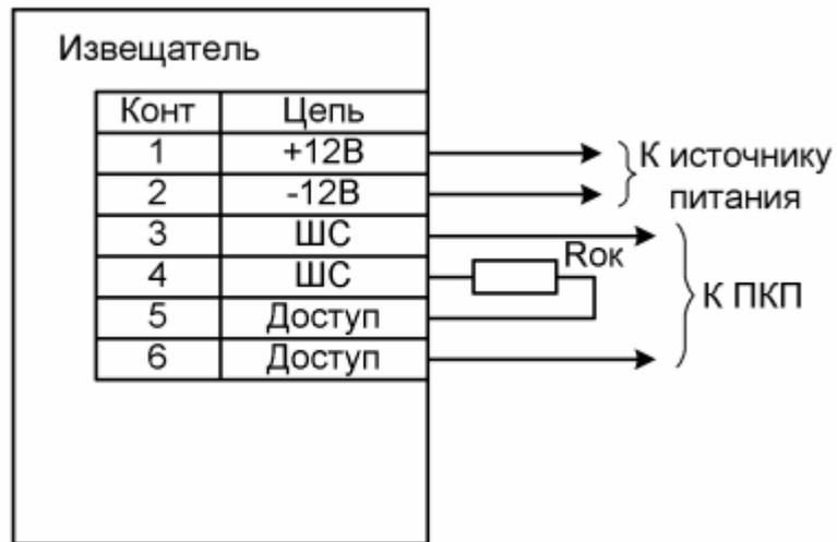
**Подключение выходного реле и датчика вскрытия в один ШС (несколько извещателей)**
