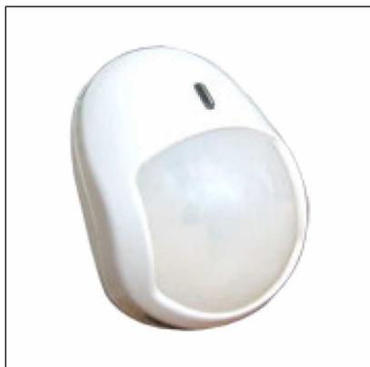
Фотон-18 служит для обнаружения проникновения в охраняемое пространство закрытого взрывоопасного помещения. При появлении человека в зоне обнаружения Фотон-18 выдает извещение о тревоге длительностью не меньше 2 с посредством размыкания контактов исполнительного реле. Извещатель устойчив к помехам от мелких животных, осветительных и отопительных приборов.
