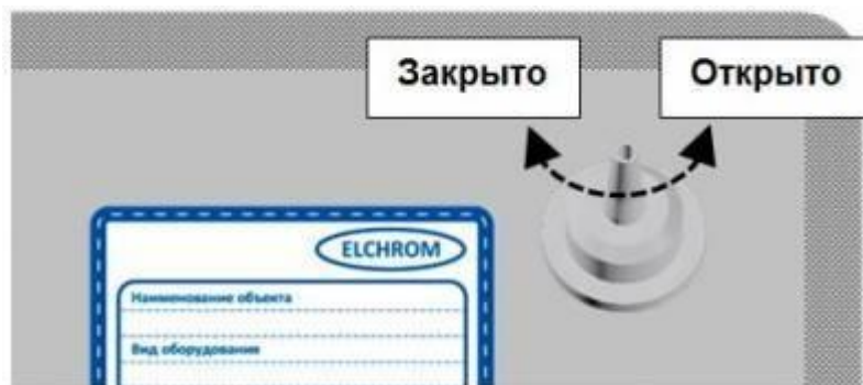
Рабочие положения клапана
