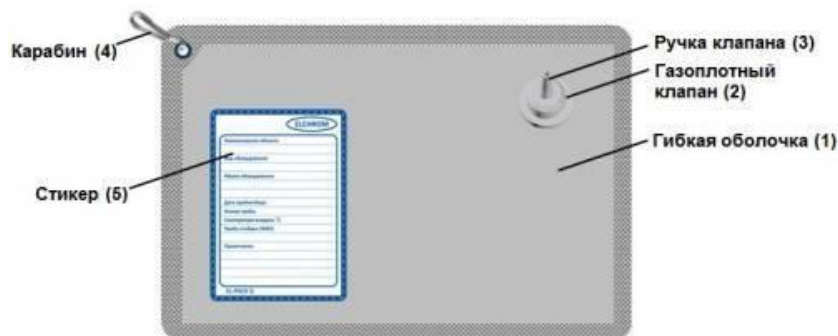
Общий вид пробоотборника (на примере EL-PACK-G-500-K2)
