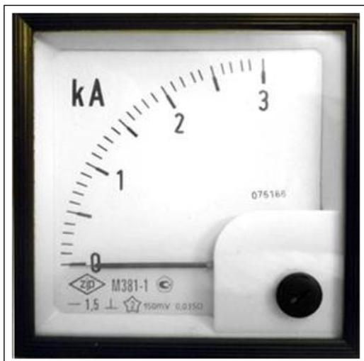
Предназначены для измерения тока и напряжения в сетях постоянного тока. Измерительный механизм магнитоэлектрической системы с внутрирамочным магнитом и подвижной частью на кернах. Класс точности 1,5.
