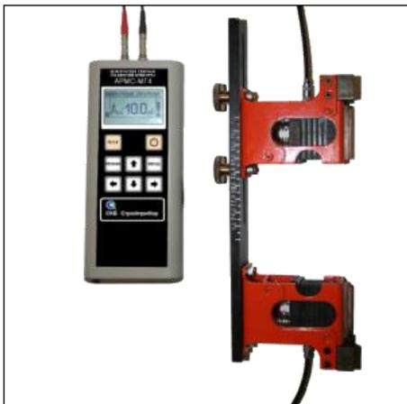
Дефектоскоп АРМС-МГ4 предназначен для контроля качества сварных стыковых соединений стержневой арматуры диаметром от 16 до 40 мм в соответствии с ГОСТ 23858, СТО 02495307-002-2008 при монтаже сборных и возведении монолитных ж/б конструкций теневым и зеркально-теневым методами.
