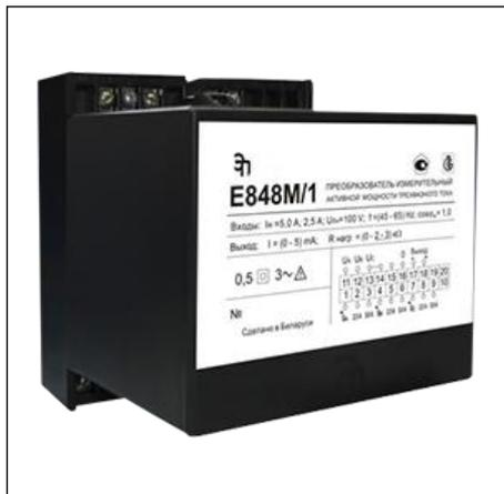
Измерительные преобразователи E848 M предназначены для линейного преобразования активной мощности трехфазных трехпроводных и четырехпроводных цепей переменного тока в унифицированный аналоговый выходной сигнал постоянного тока. Информацию несет среднее значение выходного сигнала.
