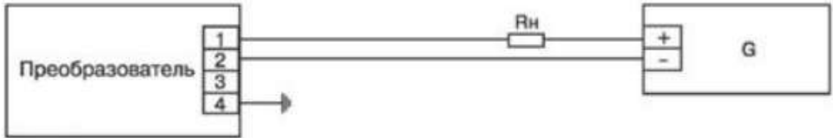
б) с выходным сигналом (4-20) мА
