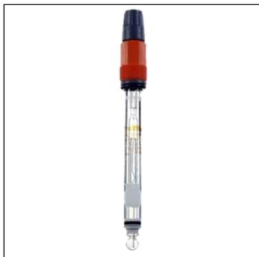
Комбинированный рН-электрод PHER-112SE предназначен для применения в загрязненной воде, содержащей твердые вещества, с низкой проводимостью > 50 мкСм/см, при температуре до 80 °С / 6 бар.
