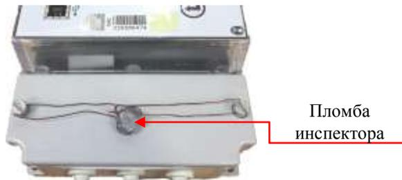
Рисунок 1.2 – Место опломбирования инспектором
