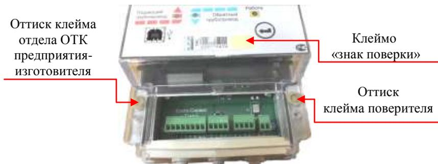
Рисунок 1.1 – Места опломбирования
