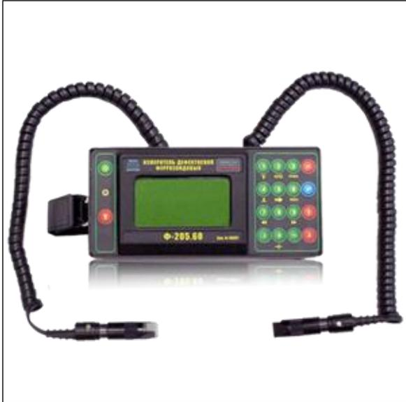
Предназначен для обнаружения дефектов в намагниченных ферромагнитных деталях, в том числе в сварных конструкциях, измерения тангенциальной или нормальной составляющей напряженности и градиента напряженности постоянного магнитного поля, оценки амплитуды и периода переменного магнитного поля, а также визуализации процесса контроля на графическом дисплее.
