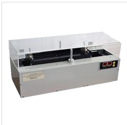
ОПСП-01 предназначено для определения показателя сцепления посыпки рулонного кровельного материала. Перемещение образца рулонного кровельного материала происходит в двух взаимно противоположных направлениях под щеткой с грузом, на заданное расстояние с заданными скоростью и количеством циклов.
