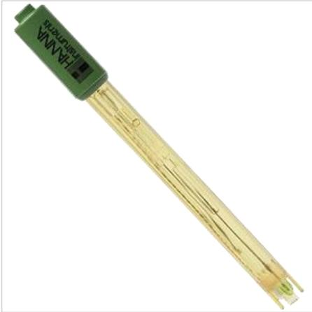
HI-12300 электрод с пластиковым корпусом, двойным солевым мостиком, гелеобразным электролитом, встроенным термодатчиком для проведения измерений с учетом термокомпенсации с помощью одного электрода.
