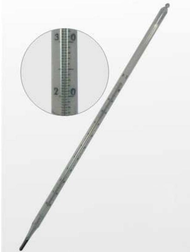
Предназначен для измерений температуры в лабораторных условиях. Конструкция: стеклянный термометр с вложенной шкальной пластиной. Диапазон измерения температуры: -30...+70°C. Цена деления шкалы: 0,5°C. Диаметр: 8,5±0,5 мм. Термометрическая жидкость: ртуть.
