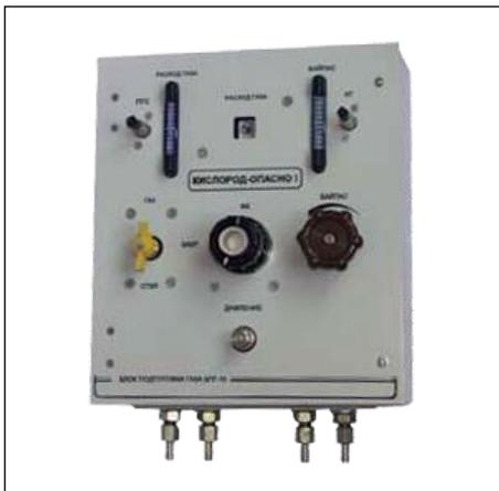
Предназначен для регулирования и стабилизации расхода и давления анализируемого газа перед подачей на термомагнитные, термокондуктометрические и опτικο-абсорбционные газоанализаторы.
