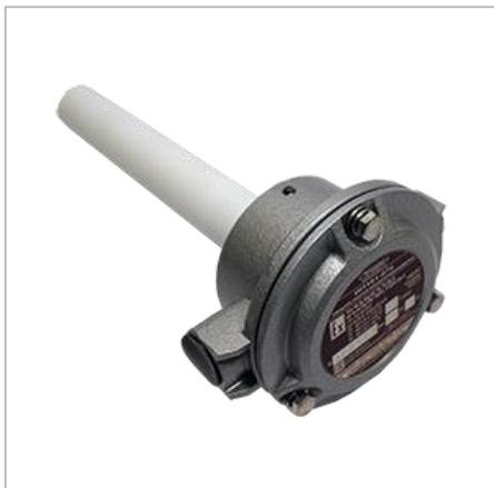
Взрывозащищенный тепловой извещатель ИП101-07е применяется в системах пожарной сигнализации и предназначен для выдачи электрического сигнала при повышении температуры окружающей среды выше заданного значения, путем размыкания или замыкания цепи шлейфа пожарной сигнализации и включения световой индикации на извещателе.
