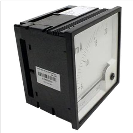
Магнитоэлектрические приборы DQ предназначены для измерения постоянного (DC) тока и напряжения. Магнитоэлектрические приборы с выпрямителем VDQ предназначены для измерения переменного (AC) тока и напряжения. Измеряют средние значения, выверенные к R.M.S. значению на синусоидальном токе/напряжении.
