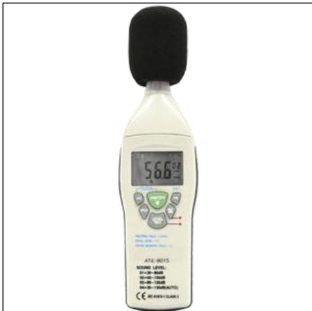
Портативный интегрирующий **измеритель уровня звука (шумомер) АКТАКОМ АТЕ-9015** предназначен для измерения уровня шума по двум шкалам А и С. В шумомере АКТАКОМ АТЕ-9015 имеется встроенный конденсаторный микрофон, он обеспечивает диапазон измерения звука в пределах от 30 до 130 дБ в полосе частот от 31,5 Гц до 8 кГц.
