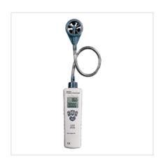
Портативный прибор DT-318 со стационарным зондом-крыльчаткой (диаметр 27,2 мм) с гибким 40-см кабелем предназначен для проведения замеров температуры и скорости воздуха в труднодоступных местах в различных офисных, складских и производственных помещениях, а также для измерений на открытом воздухе.
