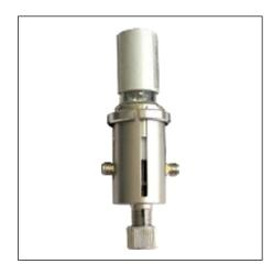
Газохроматографический детектор ХРОМДЕТ-1020 применяется при газохроматографическом анализе органических соединений. Чувствительность ФИД к органическим соединениям в 10 - 50 раз выше, чем чувствительность пламенно-ионизационного детектора.
